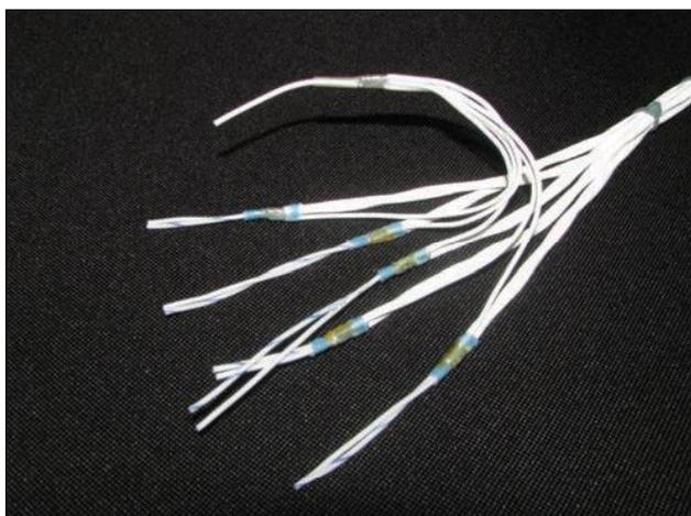
当采用衔接将屏蔽层跳线与公共接地点相连时，其要求应当 [D1D2D3] 与 8.1 “焊接衔接” 或 8.2 “压接衔接” 中注明的衔接类型（如搭接）的要求相同。
